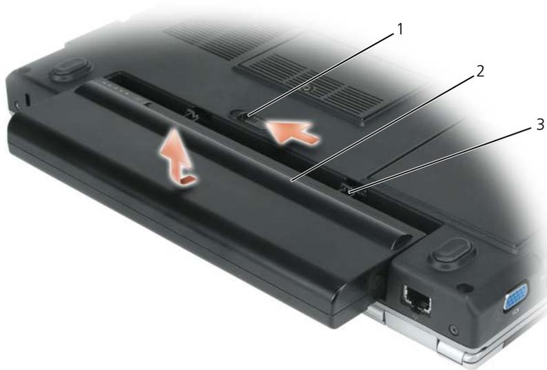
1 バッテリーベイリリースラッチ 2 バッテリー（図では 9 セルバッテリーを表示） 3 バッテリータブ（2）
