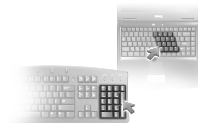
テンキーパッドは、外付けキーボードのテンキーパッドの機能と同じように使用できます。キーパッドの各キーには、複数の機能があります。キーパッドの数字と記号文字は、キーパッドキーの右側に青色で記されています。数字または記号を入力するには、キーパッドを有効にし、<Fn> とご希望のキーを押します。
