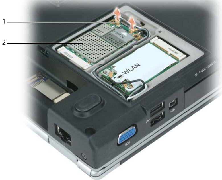
1 モバイルブロードバンドカード    2 アンテナケーブルコネクタ (2)
