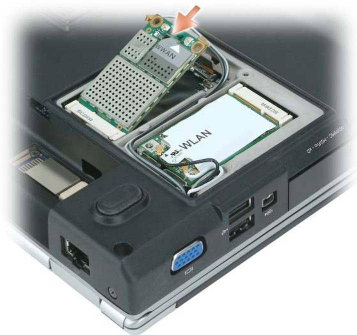
➡ **注意:** モバイルブロードバンドカードへの損傷を避けるために、カードの下にケーブルがないことを確認してください。
